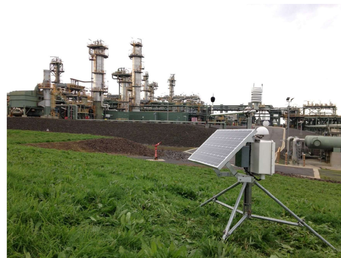
Figura 66: Autocontrol de las emisiones acústicas de industrias
